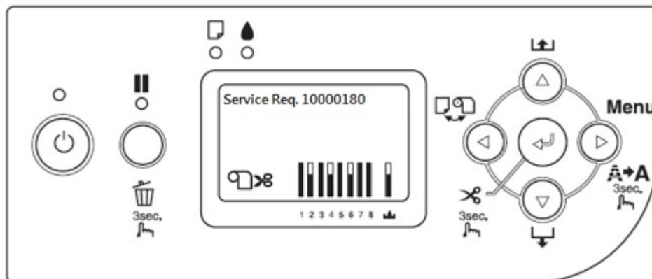
步驟 2、請先將電腦端的文件資料佇列先清除取消，印表機部分請按下「PAUSE」按鍵(3 秒)置，之後電腦端透過控制台→裝置和印表機→滑鼠游標移到 PRO 7880 機型上按右鍵→選擇印表機內容→選到連接埠，確認驅動程式的連接埠的描述是否為「EpsonNet Print Port」。
