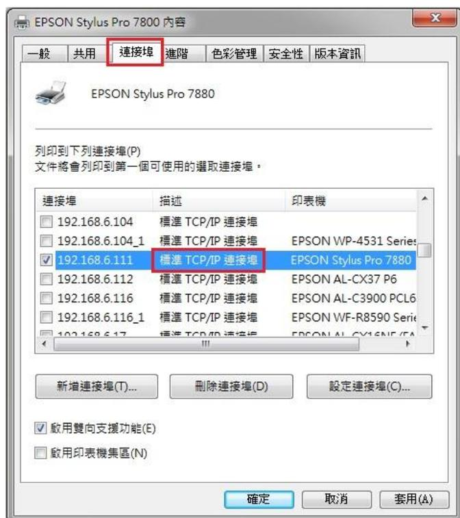
步驟 3、如果連接埠不是 EpsonNet Print Port，煩請安裝工具軟體 EpsonNet Print。安裝完成後，請到連接埠去選擇左下角「新增連接埠」，將連接埠改設定為「EpsonNet Print Port」後重新連接設定，完成後，請再重新列印測試。
